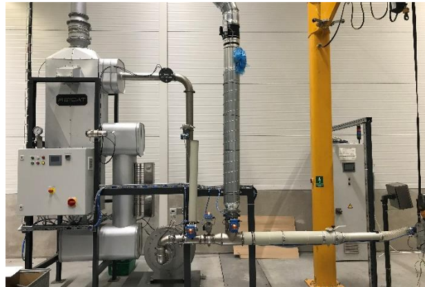
Metall- & Automobilindustrie - Lackieranlage Leistung: 600 Nm 3 /h
