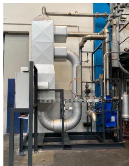
Chemische Industrie - Graphitbauteile Leistung: bis 680 Nm 3 /h
